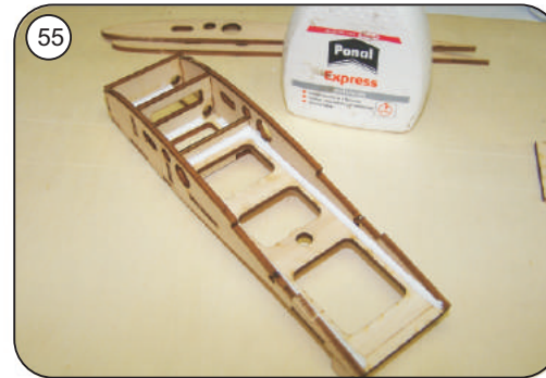
Alle Klebstellen nachträglich satt mit Holzleim vermuffen
