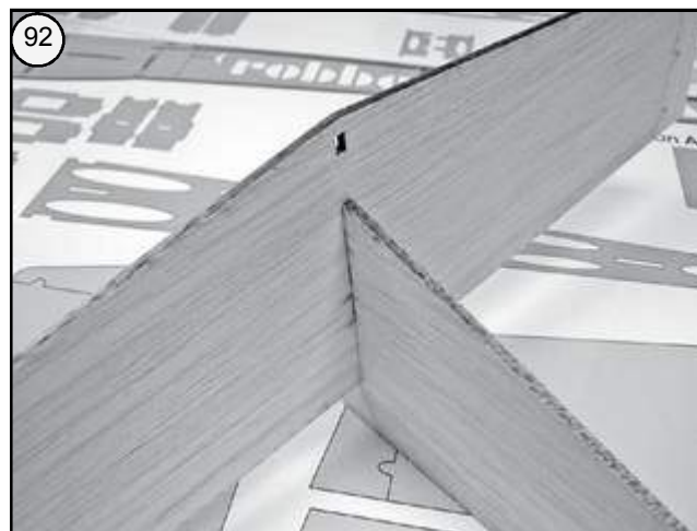
Bild 92 - Unter den Leitwerken ein Stück Klarsichtfolie auf das Baubrett legen. - Die Leitwerke ineinanderschieben, bis sie einrasten.
