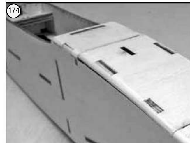
Bilder 173 und 174 - Die Kanten im vorderen Rumpfbereich leicht brechen, den gesamten Rumpfkopf überschleifen.
