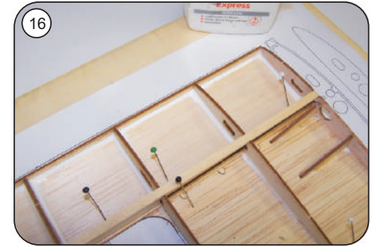
Alle Klebestellen von F 1 mit Holzleim nachkleben
