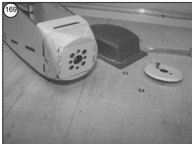
Bild 169 - Hilfsspann Mt 13 wieder abnehmen.
