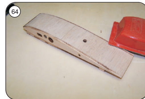
Mittelstück sauber verschleifen
