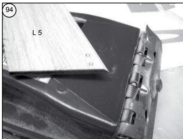
Bilder 94 - 96 - Seitenruder L 5 und Höhenruder L 6 an der vorderen Stirnkante über die ganze Länge gleichmäßig anschrägen. So ergeben sich später die ausreichenden
