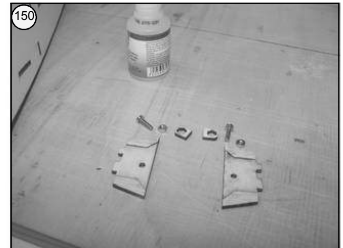
Bild 150 - Gewindeschrauben und Muttern selektieren.
