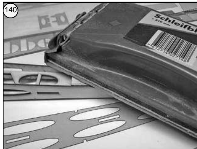
Bild 140 - Den gesamten Rumpfrohbau mit feinem Schleifpapier überschleifen.
