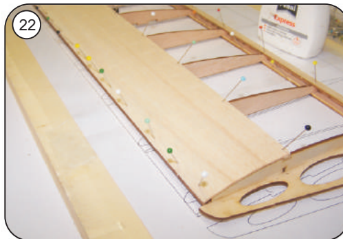
Beplankung bis zum Durchtrocknen mit Stecknadeln fixieren
