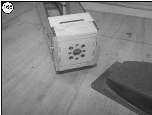
Bild 166 - Beplankungsüberstand an der Vorderkante zum Motorspant bündig verschleifen.
