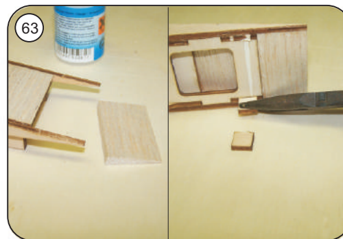
Endleiste M 14 einkleben und Stützfüsse von M 1 abbrechen
