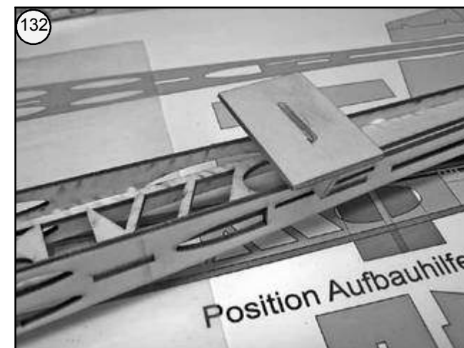
Bild 132 - Rumpf vom Baubrett lösen und umwenden.
