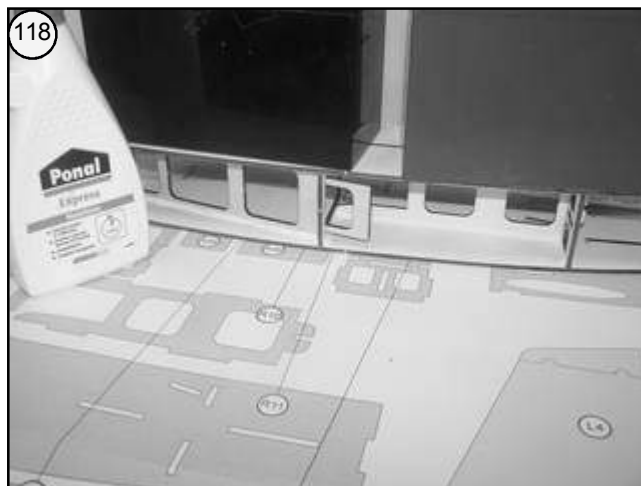
Bild 118 - Teile fixieren und mit Gewichten belegen. Alle Klebestellen gut austrocknen lassen.
