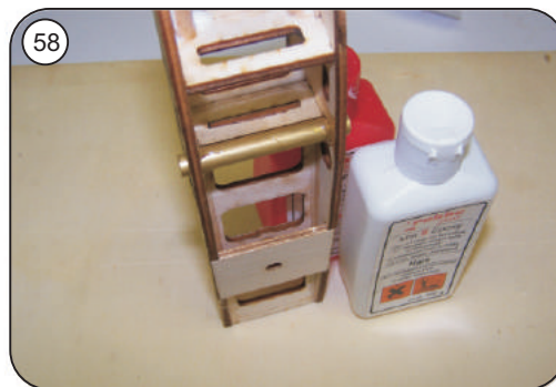
Steckungsrohr M 9 mit Epoxy einharzen
