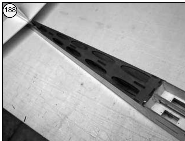
Bild 188 - Rumpfhinterteil abschnittsweise bespannen.
