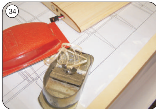
Beplankungen und Nasenleiste sauber verschleifen
