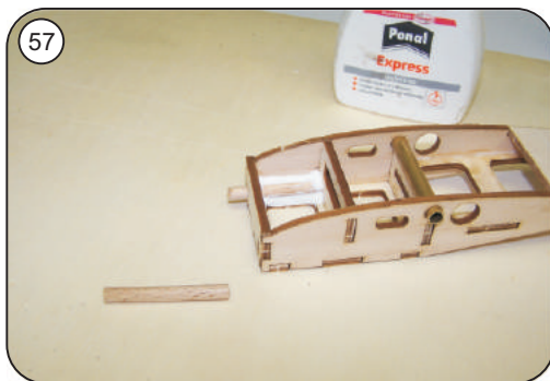
Steckungsdübel M 8 einkleben, auf gute Verklebung achten !
