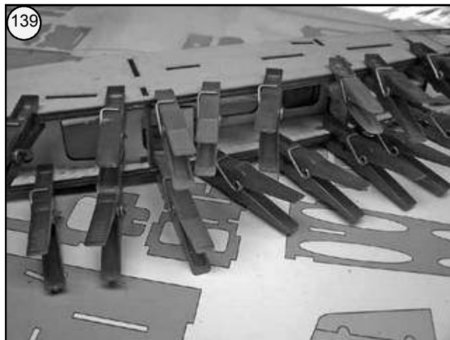
Bild 139 - Restliche Rumpfgurte R 25 - R 27 einkleben.
