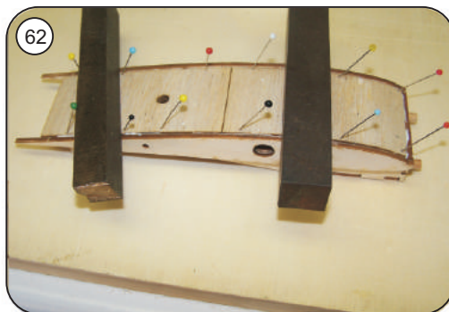
Obere Beplankung M 11 / M 12 aufkleben, nochmals Gewichte auflegen
