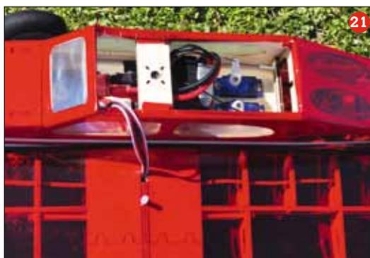
Der Rumpf bietet ausreichend Platz für alle Komponenten. Als Ausgleich für den schweren Motor sitzt der Akku im Testmodell direkt vor den Servos (21)
