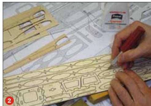
Begonnen wird mit der rechten Flächenhälfte. Die Verbindung der Bauteile kann mit Sekundenkleber oder Weißleim erfolgen (1). Die scharfe Klinge des Balsamessers trennt die Verbindungsstege bei Sperrholzteilen oder dickeren Balsaelementen (2)
