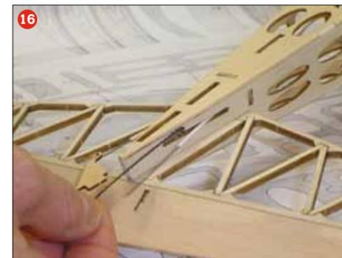
Damit der beiliegende Kabinenhaubenschluss funktionieren kann, muss der vorgesehene Schlitz im Rumpfdeckel versetzt werden (15). Die nachträgliche Anpassung der Austrittsöffnung für das Höhenrudergestänge erfolgt mit einem rundum gezahnten Laubsägeblatt (16)
