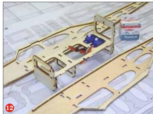
Trotz klassischer Stäbchenbauweise stammen alle Bauteile für das Höhenleitwerk aus einem massiven Balsabrett. Nach dem Aufbau erfolgt das Verschleifen der Leitwerkskanten (11). Seine extreme Stabilität erhält der Rumpf durch die zentrale Einheit aus Sperrholzspanten und massivem Servobrett (12)
