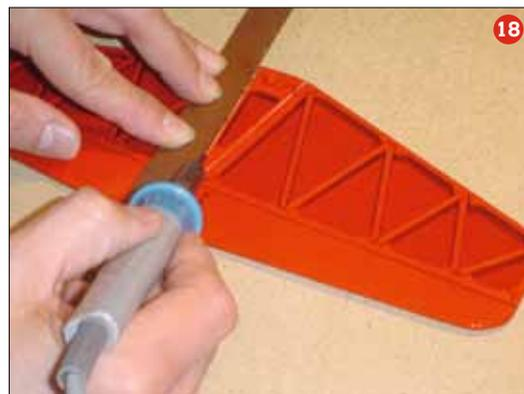
Bespannung mit Oracover-Folie. Dezentere Dekorelemente sorgen für einen klassischen Look. Die Arbeiten mit Folienbügelleisen und Fön zeigen, dass die geringe Modellgröße ein gewisses Maß an Erfahrung im Umgang mit Bügelfolie voraussetzt, um ein zufriedenstellendes Ergebnis zu erzielen.
