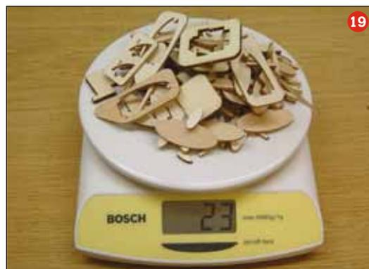
Um insgesamt 23 Gramm erleichtern die unzähligen Aussparungen den Rohbau (19)
