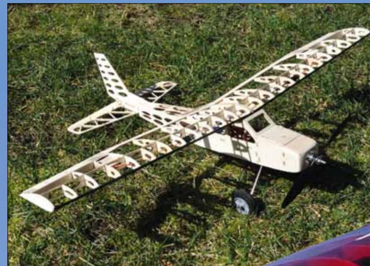
Aus sorgfältig gefertigten Lasercut-Teilen entsteht Schritt für Schritt der Charter XS von AvioTiger/robbe
