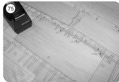
Fixez F1 et F2 avec une bande adhésive et ajustez sur le plan, collez avec une fine couche de colle instantanée
