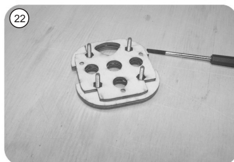
Insérez les écrous filetés M 3 dans la cloison R 12 à l'aide des vis appropriées et collez la plaque R14, puis retirez les vis.
