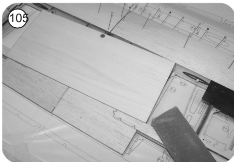
Essayez la planche intermédiaire F10, collez la avec de la colle à bois. Sécurisez avec des aiguilles. laissez sécher.
