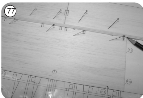
Ajustez F3 (5x2x445mm) et F3z (5x2x210mm) et collez le selon le plan
