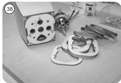
Sélectionnez les pièces pour le capot avant du fuselage / capot moteur (R28 - R36)
