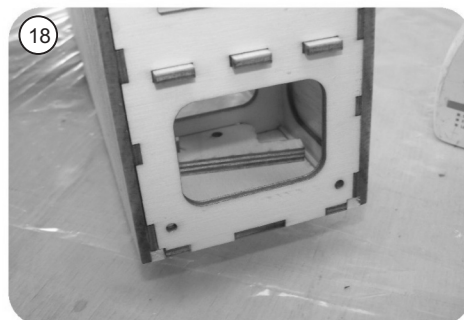
Collez R20 / R21 sur R6. Collez R22 de façon que cela soit droit. Collez les éléments intérieur R20/R21, insérez et collez à travers les cloisons, collez à ras la plaque d'appui R22
