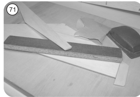
70 Poncez proprement le gouvernail de direction et l'empennage. Coupe du profil selon le plan.
