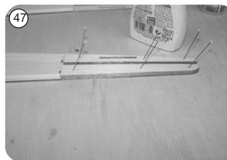
Ajustez les bandes de balsa à la longueur du fuselage R37, ajustez et collez les. Les baguettes doivent s'arrêter sur R47
