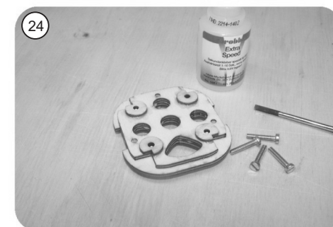
Insérez les écrous filetés M 3 dans la cloison R 12 à l'aide des vis appropriées et collez la plaque R14, puis retirez les vis.
