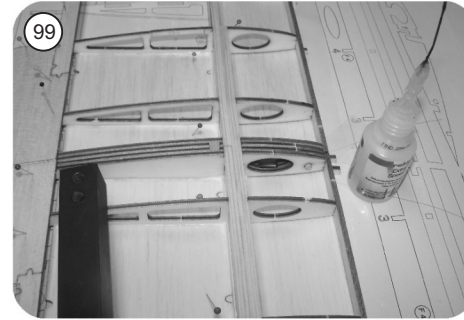
Soulevez le bord d'attaque d'aile avec des cales au niveau des nervures
