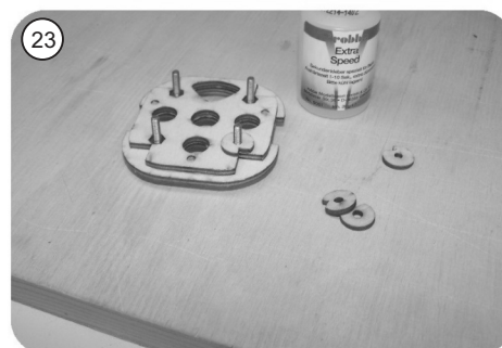
Insérez les écrous filetés M 3 dans la cloison R 12 à l'aide des vis appropriées et collez la plaque R14, puis retirez les vis.
