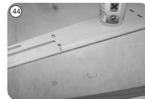
Ajustez les bandes de balsa à la longueur du fuselage R37, ajustez et collez les. Les baguettes doivent s'arrêter sur R47
