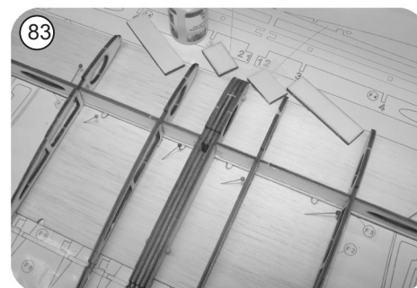
Collez F4z au milieu de F3z entre les nervures 2,3 et 3,4
