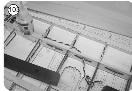
Ajustez et collez la partie supérieure et sécurisez avec des aiguilles
