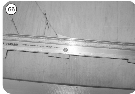
65 Lors du collage de l'ailette arrière, alignez-la avec une règle ou sur le plan et mettez-la sur le panneau de construction jusqu'à ce qu'elle soit sèche.
