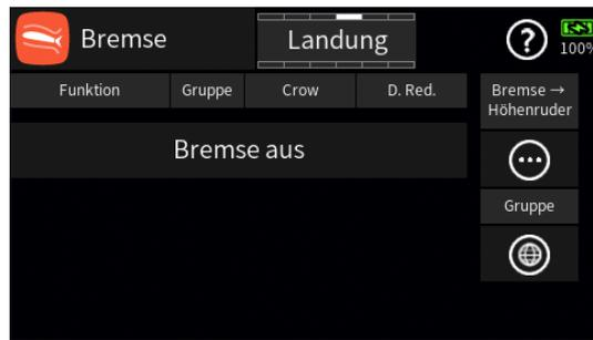
Nutzbar ist in diesem Fall nur die Option „Bremse => HR“ auf der durch Antippen des Symbols ☰ unter „Bremse => Höhenruder“ aufrufbaren Detailseite. Alle anderen Einstellmöglichkeiten sind entweder ausgeblendet oder blockiert.
