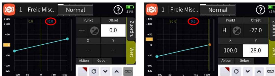
Sobald ein Punkt angetippt oder mit dem entsprechenden Geber angefahren wird, wird dieser Punkt rot dargestellt und es werden weitere Wertfelder und Symbole eingeblendet, beispielsweise:
