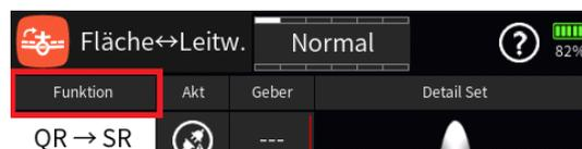
Antippen eines Feldes dieser Spalte schaltet auf die jeweils einzustellende Option um und passt die Grafik rechts unter "Detail Set" entsprechend an.
