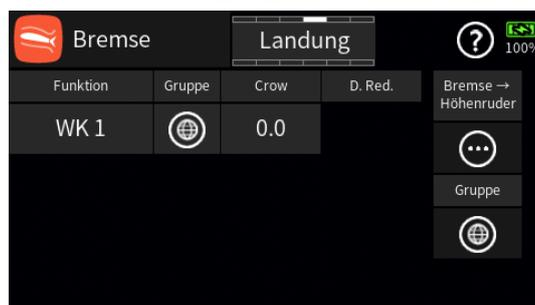
Einstellbar ist hier nur die Bremsfunktion von „WK 1“ und nach Antippen des Symbols ☰ die Option „Bremse => Höhenruder“ auf einer weiteren Displayseite.
