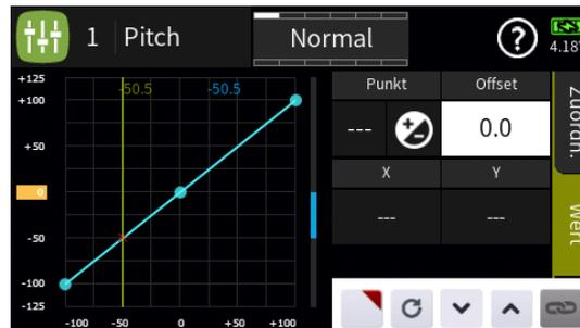
Vertikal verschoben werden kann die Steuerkurve durch Verschieben des gelben Rechteckes am linken Displayrand wie auch mit Hilfe der nachfolgend beschriebenen Einstelloptionen.
