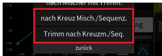
Nach Auswahl dieses Verknüpfungstyps wird das am unter „von“ definierten Steuerkanal anliegende Signal des ausgewählten Kreuzmischer- bzw. Sequenzerausgangs anteilig an den unter „zu“ definierten Zielkanal weitergereicht.
