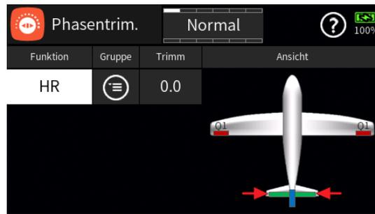
... und mit „HR“, „QR 1/2“, „WK 1/2“, „QR 3/4“ und „WK 3/4“ stehen maximal bis zu fünf Steuerfunktionen für flugphasenspezifische Trimmeinstellungen zur Verfügung:
