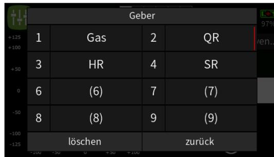
Nach Antippen des Bezeichnungsfeldes der als Vorlage dienenden Steuerfunktion wird dieser Dialog wieder ausgeblendet und im Ausgangsdisplay die zu kopierende Kennlinie braun eingeblendet:
