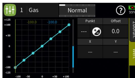
Sobald ein Punkt angetippt oder mit dem Gas-Geber angefahren wird, wird dieser Punkt rot dargestellt und es werden weitere Wertfelder und Symbole eingeblendet:
