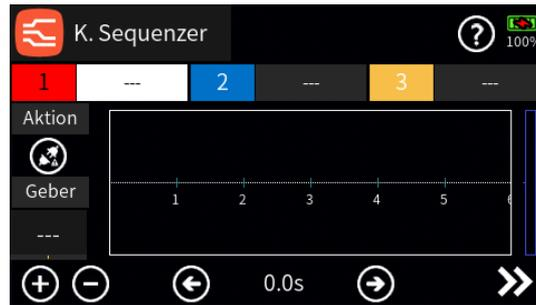
... können, startend von beliebig justierbaren Ausgangspositionen, exakt aufeinander abgestimmte Schritte von bis zu drei Servos durch Umlegen eines Schalters ausgelöst werden.
