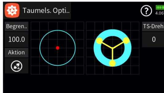
In diesem Display kann links eine Begrenzung des maximalen „Taumelscheibenausschlages“ und rechts eine virtuelle Drehung der Taumelscheibe vorgegeben werden.
