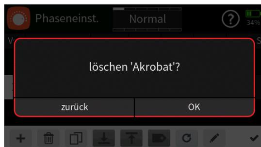
Antippen von „OK“ bestätigt den Löschvorgang, Antippen von „zurück“ bricht den Vorgang ab.
