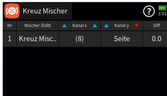
Nach Zuweisung eines Gebers im Menü „Direkt Einstellung“ des Funktions-Menüs kann dann damit diese Option während des Modellbetriebes „direkt“ justiert werden.
