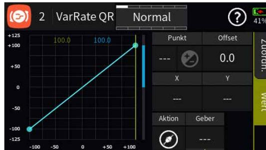
Im Ergebnis ist mit den dargestellten Einstellungen der Weg der QR-Servos mit dem Drehgeber „DV1“ stufenlos zwischen 50 und 100 % variierbar:
