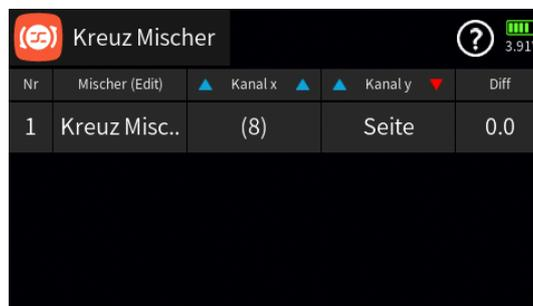
In obigem Beispiel betätigt der Seitenrudersteuerknüppel sowohl das standardmäßig an Ausgang 4 angeschlossene erste wie auch das an Ausgang 8 angeschlossene zweite Seitenruderservo.
