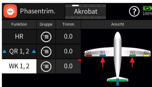
Nach Zuweisung eines Gebers im Menü „Direkt Einstellung“ kann dann damit diese Option während des Modellbetriebes „direkt“ justiert werden.
