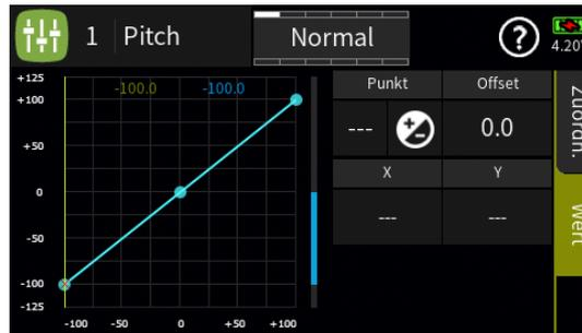
Sobald ein Punkt angetippt oder mit dem Pitch-Steuerknüppel angefahren wird, wird dieser Punkt rot dargestellt und es werden weitere Wertfelder und Symbole eingeblendet:
