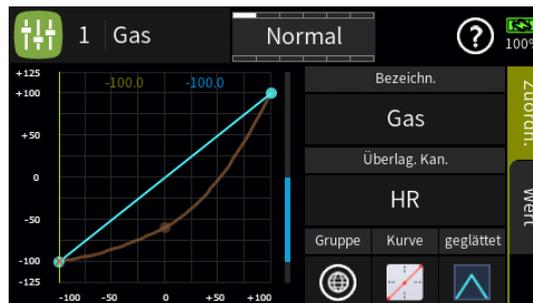
Nun kann mit den weiter hinten, im Abschnitt „Display Wert“, beschriebenen Methoden die aktuelle Kennlinie anhand der eingeblendeten justiert werden.
