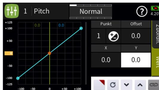
Jeder markierte Punkt kann durch Antippen des Wertefeldes unter „Y“ vertikal verschoben werden und die Punkte „1“ bis maximal „8“ durch Antippen des Wertefeldes unter „X“ ggf. auch waagrecht, und zwar ...
