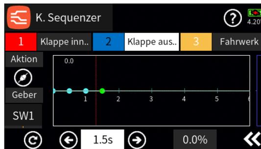
Antippen der Symbole ← → oder Betätigen des zugewiesenen Schalters verschiebt entsprechend den aktiven (grünen) Punkt auf der Zeitachse in Schritten von 0,1 Sekunden.
