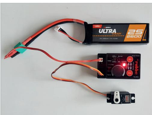
Stellen Sie das Servo mit Hilfe eines Servo Testers in seine Neutralstellung.
