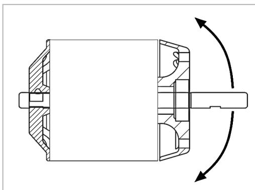
Kontrollieren Sie jetzt bereits die Laufrichtung des Motors im Uhrzeigersinn (in Flugrichtung) und tauschen ggf. zwei der drei Anschlußkabel.
