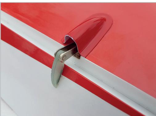
Auch die Abdeckungen der Klappengestänge werden nun auf die Oberseite geklebt.
