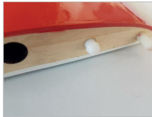
Die Torsionsstifte werden angeschliffen und bis 10mm Überstand in die Bohrungen eingeklebt. Probieren Sie zuvor den genauen Sitz im montierten Zustand inklusive dem Steckungsstab am Rumpf.
