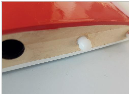
Als Flächenverriegelung zum Rumpf empfehlen wir das Multilock System. Bauen Sie dies gemäß beiliegender Anleitung ein. Alternativ kann die Fläche auch einfach mit einem Streifen Tape gesichert werden.
