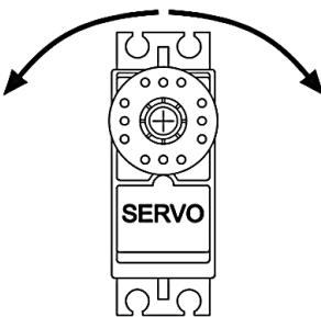
Justieren Sie zunächst, so weit möglich, alle Gestänge mechanisch. Dann erfolgt die Kontrolle und Anpassung der Servo Laufrichtungen und -wege gemäß Tabelle unten.
