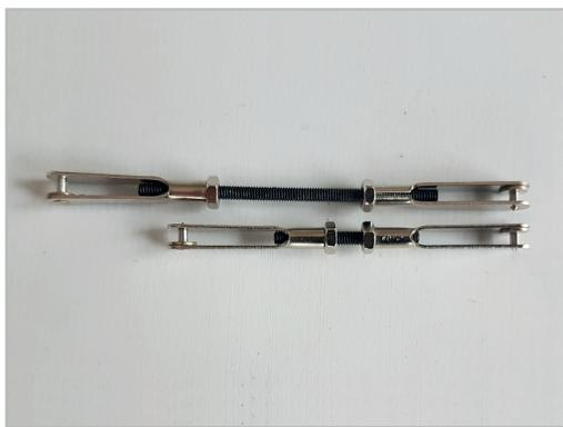
Fertigen Sie nun die Gestänge in den entsprechenden Längen an. Querruder ca. 56mm, Klappen ca. 72mm.
