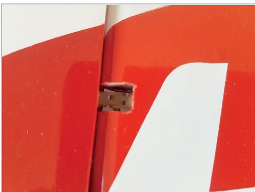
Kleben Sie die Scharniere des Seitenruders mit Epoxy in die Bohrungen. Achten Sie darauf, dass sich der Drehpunkt genau im Radius der Rundung des Seitenruders befindet.
