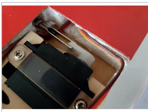
Die Gestänge der Klappen sollten so eingestellt werden, dass bei Ausschlag nach unten das Gestänge zum Servohebel „verkniet“, also einen 180° Winkel bildet. Damit wird das Servo bei Vollauschlag der Klappe entlastet.
