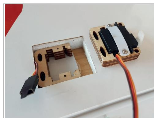
Kleben Sie die Servorahmen mit Epoxy Harz seitlich bündig in die Servoschächte. Die Richtung des Servoabtriebs ergibt sich durch die Ruderhorn Position.
