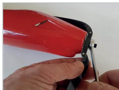
Befestigen Sie anschließend den Propeller auf der Motorwelle durch bedachtes Anziehen der Mutter. Nun kann die Spinnerkappe montiert werden.
