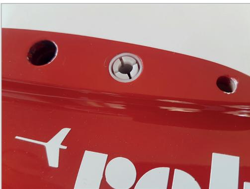
Als Flächenverriegelung empfehlen wir das Multilock System. Bauen Sie dies gemäß beiliegender Anleitung ein. Alternativ kann die Fläche auch einfach mit einem Streifen Tape gesichert werden.
