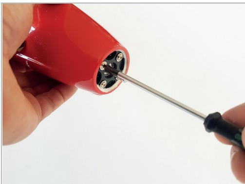
Schrauben Sie den Motor mit den Kabeln nach unten zeigend hinter den Motorspant. Verwenden Sie Schraubensicherungslack.
