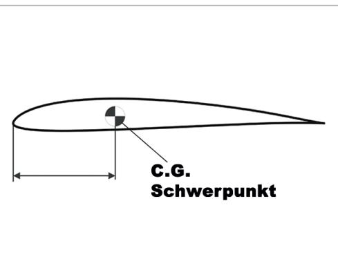
Der Schwerpunkt liegt bei 88-90mm hinter der Nasenleiste. Für einsteigertauglicheres Flugverhalten setzen Sie den Schwerpunkt mit Verschieben des Akkus zunächst auf 86mm. Für leistungsoptimiertes Verhalten kann der Schwerpunkt langsam weiter nach hinten verlegt werden.
