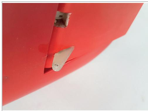
Nun wird das Seitenruderhorn ebenfalls nach Anschleifen mit Epoxy eingeklebt.
