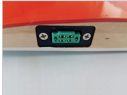
Wir empfehlen die elektrische Verbindung mittels MPX Stecker zu montieren, zumal der MONSUN bereits für den Einbau der schwarzen Rahmen vorgesehen ist. Dies erspart Ihnen später Kabelgewirr beim Aufbau auf dem Flugplatz.
