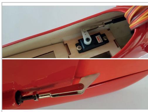
Hängen Sie die Gabelköpfe in das Seitenruderhorn und in das dritte Loch des Servohabels. Montieren Sie den Servohobel im 90° Winkel und schrauben ihn fest.
