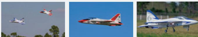
Le FlexJet combine l'aérodynamique moderne avec la pratique et la performance des jets sportifs. Le concept de base moderne comprend des caractéristiques innovantes telles qu'une aile Delta clappée, des LERX (Leading Edge Root Extensions) et un bord d'attaque en « Dog Tooth », qui offre d'excellentes caractéristiques de vol grâce à son grand angle d'attaque.
