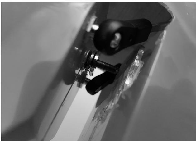
Legen Sie nun das Drucklager auf den Führungstift des Seitenruders und fädeln es in die Aufnahme des Rumpfes ein. Die Seile hängen nun in den Rumpf hinein. Es hat sich bewährt, bei diesem Vorgang den Rumpf 90° auf die Seite zu legen.
