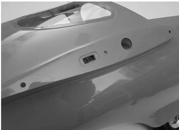
Für die elektrische Verbindung Rumpf/Fläche werden die 6-poligen Multiplex Stecker verwendet, die wahlweise lose belassen oder fest eingebaut werden können.
