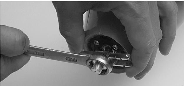
Montieren Sie das Luftschrauben Mittelteil auf der Motorwelle. Achten Sie auf ein festes, aber gefühlvolles Anziehen der Mutter. Es handelt sich hier um ein Aluminium Gewinde!
