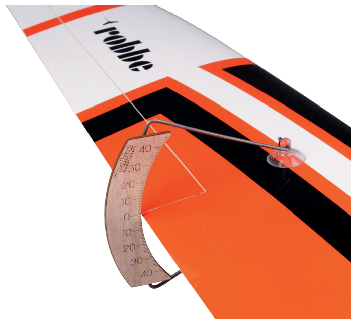
RUDEAUSSCHLAG LEHRE RUDDER DEFLECTION GAUGE DÉBATTEMENT DE LA BARRE JAUGE
