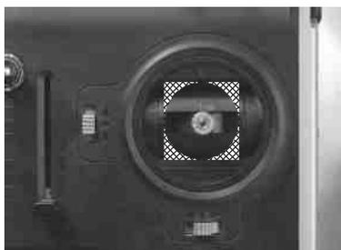
Diese Funktion ermöglicht die Ansteuerung von bis zu drei der so genannten Voith-Schneider-Antriebe bei Schiffsmodellen. Die Funktion erscheint nur dann im Multifunktionsmenü wenn der Modelltyp „Boot“ ausgewählt wurde.
