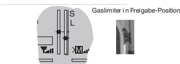
Beim Modelltyp „Heli“ hat die K1-Trimmung in Verbindung mit der „Gaslimit-Funktion“ eine weitere Eigenschaft. Solange sich der Gaslimit-Geber in dem Bereich -1 bis -100% befindet, dann wirkt die K1-Trimmung als Leerlauftrimmung auf das Gasservo und die Anzeige der Leerlauftrimmung ist im Display sichtbar.
