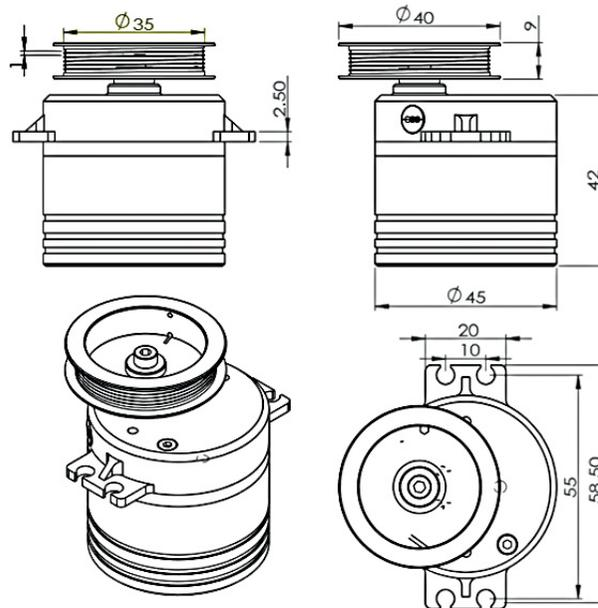
Die Robbe FSW 220 Segelwinde ist eine extrem starke, robuste und präzise Winde mit einem wasserdichtem CNC Alugehäuse (IP68), Vollmetallgetriebe und doppelt kugelgelagertem Abtriebsrad aus Stahl, welche für extreme Belastungen und Langlebigkeit ausgelegt wurden.
