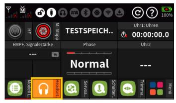
Um diese Option nutzen zu können, ist zuvor der Bluetooth-Anschluss zu aktivieren und dieser mit einem Bluetooth-Headset gekoppelt werden.
