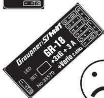
Der Empfänger muss rechtwinklig zu einer Achse des Copters auf der Empfängerplattform ausgerichtet werden. Es muss immer die untere Fläche des Empfängers parallel zu einer Copterachse liegen. Entfernen Sie vor der Montage den Aufkleber auf der Empfängerrückseite und verwenden Sie optional die Doppelklebepads S8376 für Gr-18.
