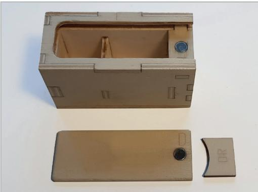
Testen Sie, ob sich der Deckel leicht in die Box schieben lässt. Ohne Griff Bauteil (DR) kann man den Deckel nur sehr schwer aus der Box herausziehen, da die Magnete den Deckel sehr gut festhalten. Sie können einen Faden um den Deckel legen, mit dem Sie den Deckel wieder vorziehen können. Sollte der Deckel schwergängig sein, können Sie den Deckel auf der Unterseite flächig dünner schleifen. Achten Sie hierbei auf den Magneten.
