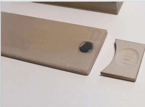
Kleben Sie den Griff DR auf den Deckel D. Sollte der Magnet leicht aus dem Deckel nach oben herausstehen, können Sie in den Griff DR eine Vertiefung schleifen. Schleifen Sie alle Überstände an den Außenseiten der Box plan. Die Ecken und Kanten können Sie leicht abrunden, damit die Box sich besser in der Hand anfühlt.
