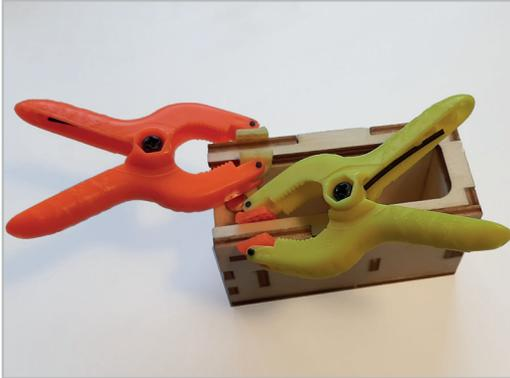
Kleben Sie die obere Abdeckung E mit Weißleim in die Box. Auf der Seite des Magneten müssen Sie die Abdeckung an die Box anklammern. Wischen Sie überschüssiges Weißleim ab und achten Sie insbesondere darauf, dass kein Kleber in die Führung des Deckels gelangt.
