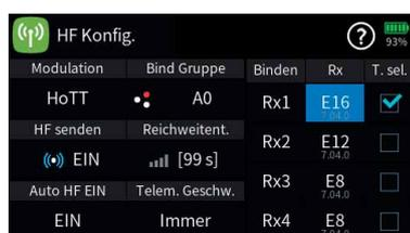
Der Sender **mz-32 HoTT** unterstützt das Binden von bis zu 4 **Graupner** HoTT-Empfänger je Modellspeicher. Jeder dieser Empfänger ist einzeln zu binden und der jeweils zuletzt gebundene Empfänger wird durch Setzen des entsprechenden Häkchens in der Spalte „T. sel.“ als Hauptempfänger definiert, siehe Abbildung links. Nach dem Binden aller benötigten Empfänger ist ggf. dieses Häkchen durch Antippen des entsprechenden Wertefeldes in die Zeile des gewünschten Empfängers zurück zu versetzen.
