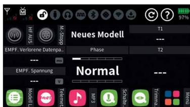
Dieses Display ist, genauso wie fünf weitere, mit Ausnahme der Kopfzeile auf einfache Weise komplett frei konfigurierbar. Wie das im einzelnen vonstatten geht, erläutert der kontextbezogene Hilfetext: Die insgesamt sechs frei editierbare Seiten können beliebig mit den beiden oberen Tasten links vom Display Tasten oder durch Wischen nach links oder rechts angewählt werden.
