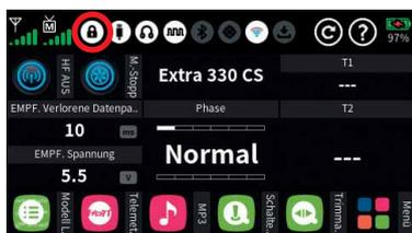
In der Grundanzeige des Senders wird die Eingabesperre des Bildschirms durch ein ca. 1 Sekunde währendes gleichzeitiges Drücken der beiden unteren Auswahltasten aktiviert.
