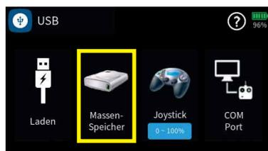
Firmware Updates des Senders werden über die rückseitige Micro-USB-Buchse und der senderseitigen Einstellung „Massenspeicher“ mit Hilfe eines Laptops oder PCs mit Windows 7 ... 10 durchgeführt. Die benötigten Programme und Dateien sind in einem Software-Paket zusammengefasst und sowohl im Verzeichnis „Util“ auf dem Massenspeicher des Senders **mz-32 HoTT** als auch beim entsprechenden Produkt auf [www.graupner.com](http://www.graupner.com) zu finden.
