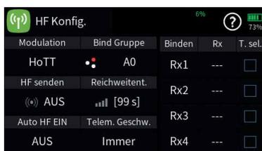
Bei einem ungebundenen Modellspeicher ist nach dem Öffnen des Menüs standardmäßig die nächste freie Bindungsgruppe voreingestellt. Solange der Modellspeicher ungebunden ist, kann jedoch diese Vorgabe bei Bedarf im linken Wertefeld dieser Option geändert werden:
