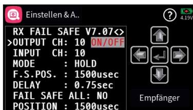
5. Abhängig von der am gewählten Empfängerausgang anzuschließenden RC-Komponente den Standardwert „PULSE“ belassen oder auf „ON/OFF“ umstellen.
