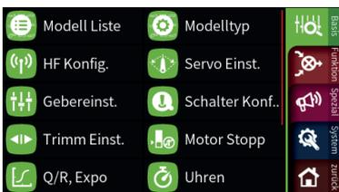
Antippen des Feldes „Menü“ unten rechts im Hauptdisplay wechselt zur zuletzt aktiven der mit „Basis“, „Funktion“, „Spezial“ und „System“ bezeichneten vier Registerkarten bzw. Menülisten.
