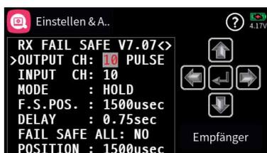
4. In der Zeile „OUTPUT CH“ ggf. den zu schaltenden Empfängerausgang, wie unter „Funktion des kreuzförmigen Tastenfeldes“ beschrieben, auswählen.
