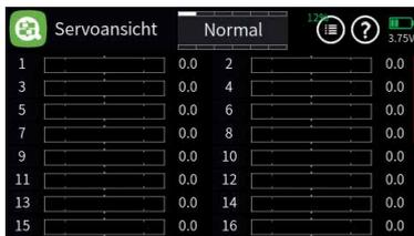
Befinden sich alle selbst rückstellenden Steuerknüppel in ihrer jeweiligen Mittelstellung, sollte die Anzeige der Steuerkanäle 1 ... 4 oder 2 ... 4, falls der K1-Steuerknüppel auf nicht selbst rückstellend umgestellt ist, wie in der Abbildung links aussehen.
