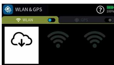
Zum Einschalten der WLAN-Funktion des Senders ist der Schalter durch Antippen von der AUS- (OFF) in die EIN-Position (ON) zu bringen, und umgekehrt:
