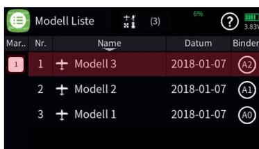
Dieses „Binding“ oder „Binden“ eines Empfängers erfolgt beim Sender **mz-32 HoTT** standardmäßig immer im Rahmen einer so genannten Bindungsgruppe, wobei beim Binden eines ungebundenen Modellspeichers automatisch immer die nächste freie Gruppe vorgeschlagen wird. Solange dieser Vorschlag stets übernommen wird ist sichergestellt, dass sich jeder Modellspeicher in einer eigenen Bindungsgruppe befindet. Im Regelfall also eine modellspezifische Bindung erfolgt.
