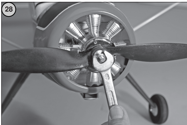
Bild 28 - Die Luftschraube mit Konus und Spinner-Rückwand montieren. Zwischen Sternmotor-Attrappe und Spinner-Rückwand einen Spalt von ca. 4 mm einstellen
