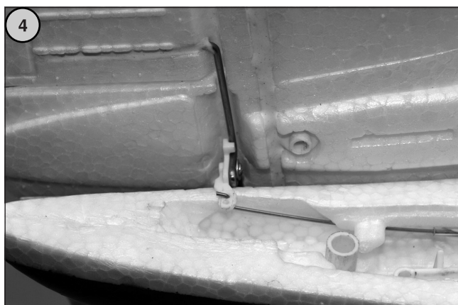
Bild 4 - Gestänge im Ruderhorn des Höhenruders einhängen. Höhenleitwerk auf das Rumpfeinde setzen.
