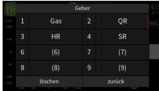
Nach dem Antippen des Bezeichnungsfeldes der als Vorlage dienenden Steuerfunktion wird dieser Dialog wieder ausgeblendet und im Ausgangsdisplay die zu kopierende Kennlinie braun eingeblendet:
