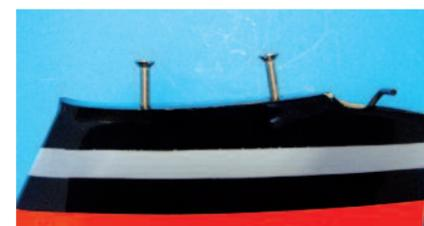
In beiden Versionen sind die Gewinde für die HLW-Verschraubung auf der Seitenflosse fertig eingebaut. Ein kleiner Klebestreifen half das Leitwerk im korrekten Winkel zur Fläche auszurichten. Das Höhenruder wird beim Aufschrauben des Leitwerks in einen Anlenkungsdraht eingehängt. Aufgrund der Führung des Anlenkgestänges kann es nicht herausrutschen.
