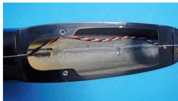
auf dem Gewindebereich gegönnt. Ebenso den fertig in ein Messinggewinde eingedrehten Ruderhörnern in den Querrudern. Das Ziel war die absolute Minimierung des Spiels. Gleiches gilt für das Höhenruderservo. Es sitzt aus Platz- und Schwerpunktgründen in der Seitenflosse und ist ebenfalls eingeklebt. Ein 2 mm-Stahldraht, der durch die Flosse geführt wird, lenkt das Höhenruder spielfrei an.
