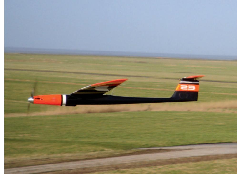
Wegdrehens des Modells bei minimaler Fahrt im Start sehr hoch. In der Luft schauen die anderen allerdings hinterher, wenn der *Limit PRO* ihnen mit diesem Antrieb einfach davon zieht. Beindruckend. Der Schwerpunkt ist mittlerweile auf 75 mm zurückverlegt, die EWD auf 0,25 Grad reduziert. Der *Limit PRO* schießt jetzt ganz anders durch sein Element, als mit der eher gutmütigen Ersteinstellung.
