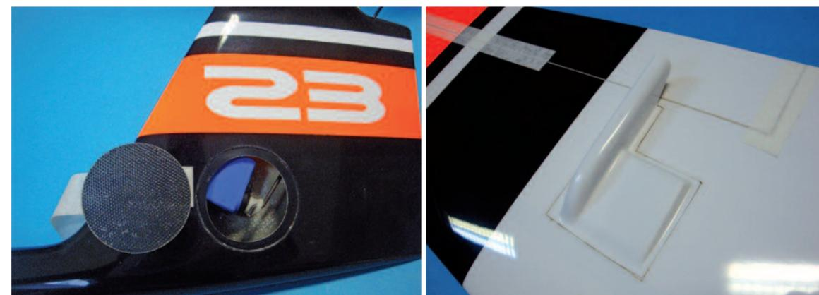
Die Servoabdeckungen passen gut in die dafür vorgesehenen Sicken in Flächen und Seitenflosse. Die Ruderhörner für die Querruder werden einfach in vorbereitete Gewinde eingeschraubt und nach endgültiger Ausrichtung der Gestänge mit einem Tropfen Sekundenkleber gesichert. In der PNP-Variante sind die 1 Servos schon fertig an die Ruder angeschlossen.
