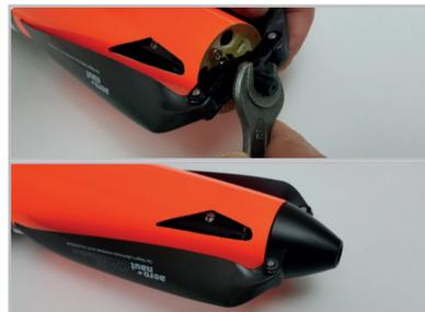
Monter les pâles sur le porte pâles et fixer le porte pale sur l'axe du moteur en serrant avec modération mais suffisamment pour que cela soit fixé. Veillez à ce que tous les éléments rotatifs soient correctement et solidement en place ! Une installation défectueuse peut présenter un risque pour la sécurité et causer des blessures corporelles et des dommages matériels !
