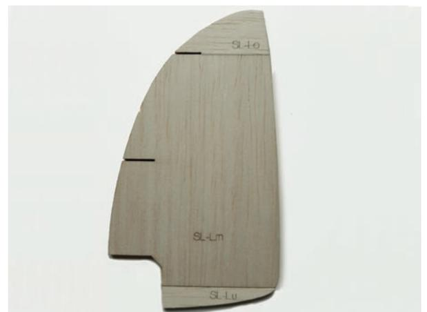
Kontrollieren Sie mit dem 4 mm CFK-Stab, dass kein Weißleim in der Aussparung ist. Entfernen Sie den CFK-Stab zum Trocknen, er wird später eingeklebt.
