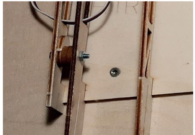
Setzen Sie die zusammengesteckten Teile und die Rippen 3 und 4 in die Helling ein.
