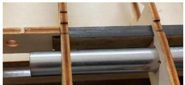
Drücken Sie weitere Rippen provisorisch in die Helling ein und setzen Sie den Holmsteg auf die Rippen. Jetzt können Sie den Steckungskasten bis zum Anliegen am Holmsteg nach innen schieben.
