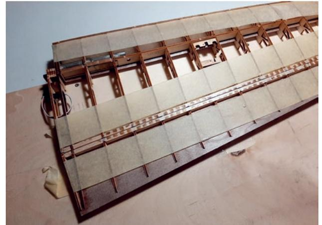
Schleifen Sie die zwei Klappenstege auf die Höhe der Rippen runter. Nutzen Sie auch hier die Schleifplatte. Beim Schleifen müssen Sie darauf achten, dass Sie den Anschlag der oberen Beplankung an den Rippen nicht wegschleifen. Schleifen Sie aus diesem Grund nur auf der Seite zur Endleiste.
