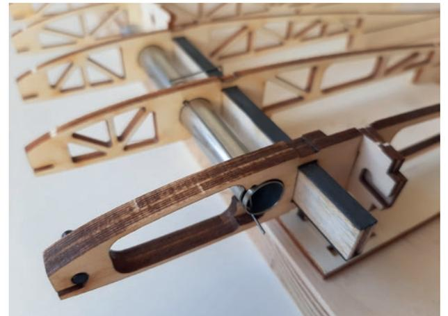
Setzen Sie die Befestigung des Flächenriegels in Rippe 1 ein. Bei der rechten Fläche ist der Ausschnitt für den Flächenriegel vorne, die Rundung des „P“ zeigt nach oben. Die Beschriftung muss richtig herum zu lesen sein. Testen Sie unbedingt vor dem Einkleben, ob der Riegel problemlos in den Ausschnitt passt. Jetzt können Sie noch leicht nacharbeiten.
