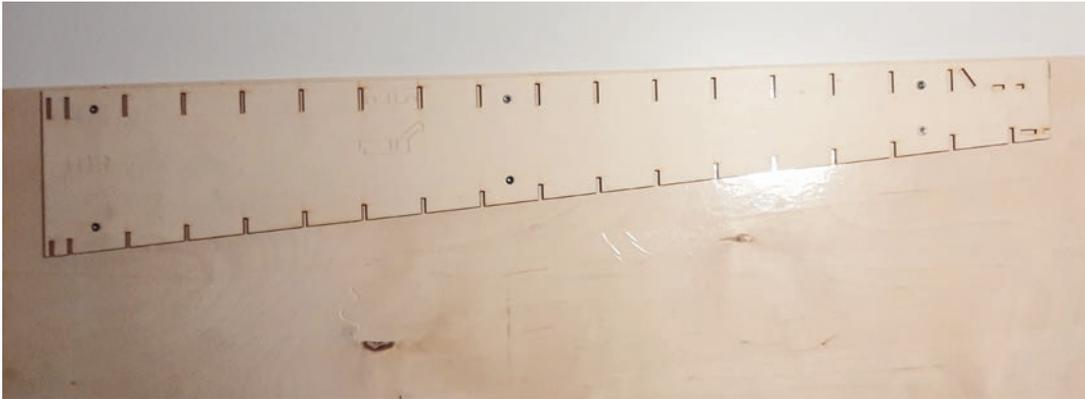
Die Helling können Sie mit mehreren Schrauben, Tackerklammern oder flächig mit dünnen Doppelklebeband auf dem Baubrett befestigen. Achten Sie darauf, dass die Helling komplett plan aufliegt.
