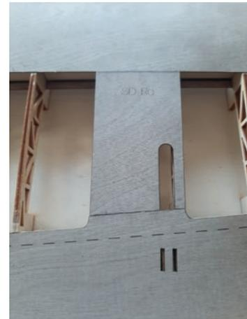
Bei der Beplankung des Servokastens müssen Sie darauf achten, dass kein Weißbleim in den Bereich des Servorahmens gelangt, da ansonsten das Servo später nicht weit genug in den Servorahmen gedrückt werden kann.
