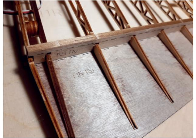
Bearbeiten Sie die Aussparungen des hinteren Klappenstegs entsprechend und setzen Sie den hinteren Klappensteg mit etwas Abstand zum vorderen ein. Um einen gleichmäßigen Abstand zu erhalten, können Sie ein Reststück der Beplankung verwenden. Dieser Abstand erleichtert später das Abtrennen der Querruder. Kontrollieren Sie wieder, ob der Klappensteg auf der unteren Beplankung aufliegt und kleben Sie ihn fest.
