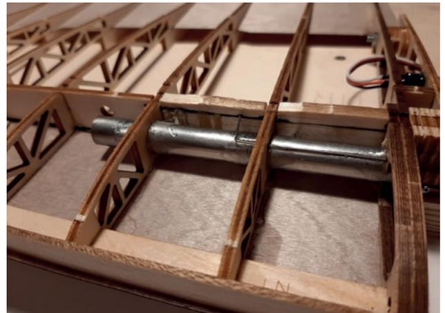
Tragen Sie jetzt auch auf der anderen Seite der Rippen Kleber auf und drehen Sie das Rohr noch etwas, damit sich der Kleber gut verteilt.
