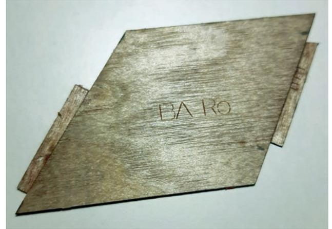
Nachdem die Laschen angeklebt sind, sollten Sie noch einmal testen, ob die Beplankung in den freien Bereich zwischen vorderer und hinterer Beplankung passt.
