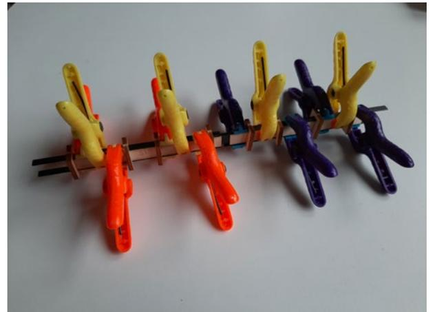
Schneiden Sie den Überstand der CFK-Leisten L2 ab und schleifen Sie eine Seite des Steckungskasten an der Öffnung für die Steckung plan. Seitlich müssen Sie nicht schleifen.
