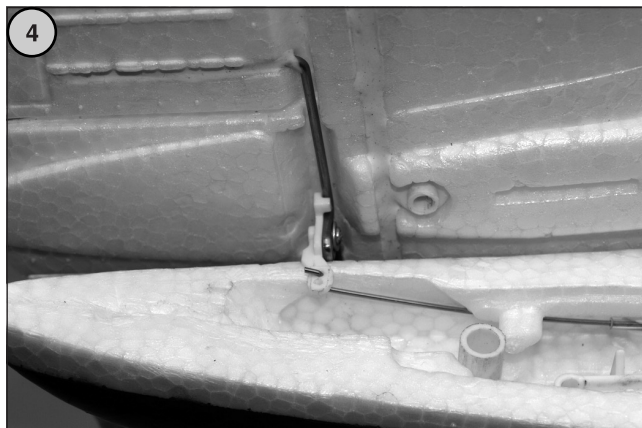
Fig. 4 - Accrochez la tringle dans le guignol de la gouverne de profondeur. Installez le stabilisateur sur la queue du fuselage.
