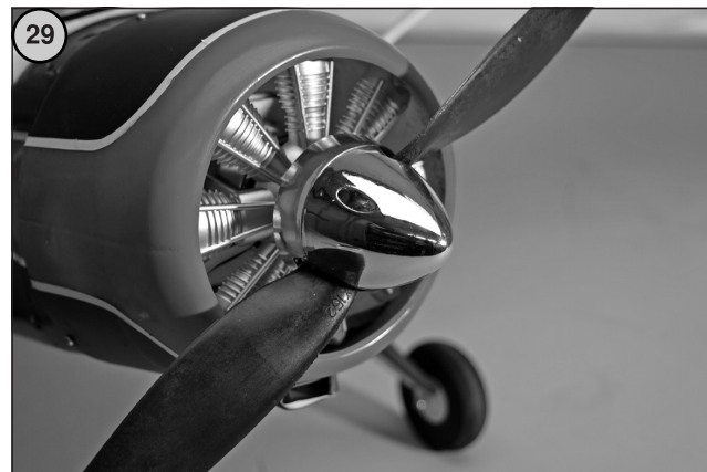
Fig. 29 Mettez le capuchon du cône d'hélice en place et fixez-le.
