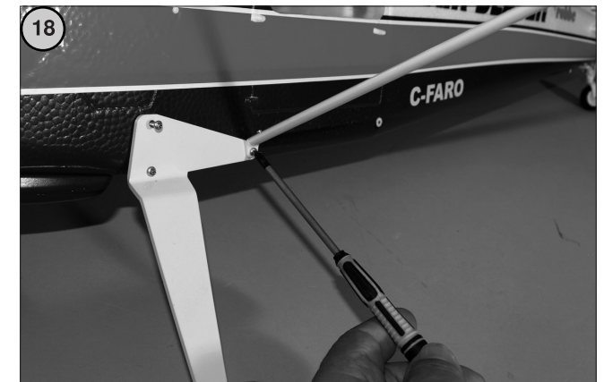
Fig. 18 - Vissez l'atterrisseur principal au fuselage en vissant simultanément les étais de la voilure.
