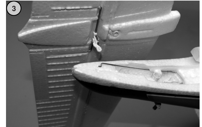
Fig. 3 - Tirez la tringle de profondeur vers l'arrière.
