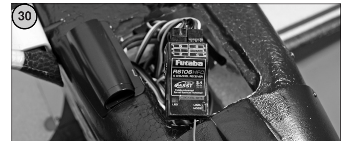
Fig. 30 Pour les travaux qui suivent, observer également les instructions fournies par la notice de l'ensemble de radiocommande. - Affectez les diverses fonctions en raccordant les servos aux voies appropriées du récepteur. - Connectez le variateur. - Installez le récepteur. - Agencez l'antenne souple du récepteur selon les indications de la notice de l'ensemble de radiocommande. - Collez deux rubans de bande auto-agrippante (accroche) dans le logement de l'accu pour sa fixation.
