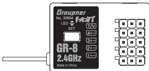
CH3> Stecken Sie das Adapter-Kabel in die Buchse (CH 3) des Empfängers. Das Stecksystem ist verpolungssicher, achten Sie auf die kleinen seitlichen Fasen. Wenden Sie auf keinen Fall Gewalt an, der Stecker sollte leicht einrasten.
